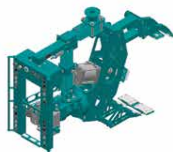
CHWYTAK OBROTOWY DO ZBIORNIKÓW
