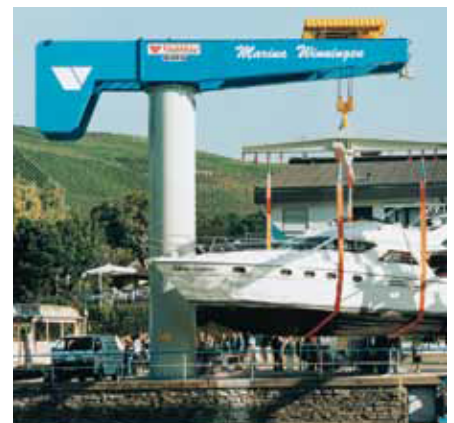
Typ: BOSS Udźwig: 32.000 kg Dł.ramienia: 7.500 mm Lokalizacja: D-Winningen / Mosel
