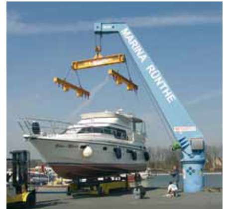
Typ: MAAT Udźwig: 16.000 kg Dł.ramienia: 6.000 mm Lokalizacja: D-Bergkamen / Datteln-Hamm Kanal
