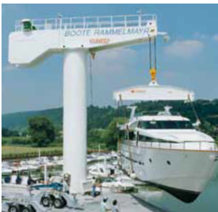
Typ: BOSS Udźwig: 63.000 kg Dł.ramienia: 7.500 mm Lokalizacja: D-Saal / Donau
