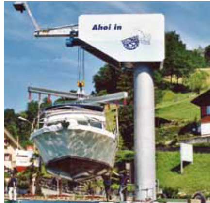
Typ: MEISTER Udźwig: 8.000 kg Dł.ramienia: 5.000 mm Lokalizacja: CH-Vitznau / Vierwaldstättersee
