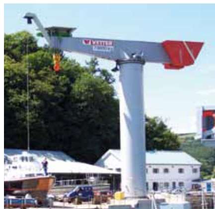
Typ: BOSS Udźwig: 70.000 kg Dł.ramienia: 7.000 mm Lokalizacja: GB-Dartmouth / Dart
