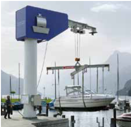
Typ: MEISTER Udźwig: 6.300 kg Dł.ramienia: 5.500 mm Lokalizacja: CH-Brunnen / Vierwaldstättersee
