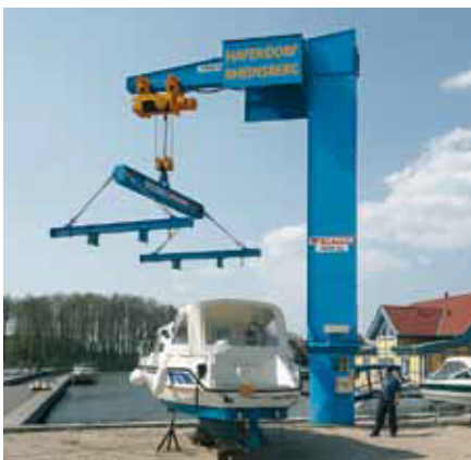
Typ: BOSS Udźwig: 20.000 kg Dł.ramienia: 6.000 mm Lokalizacja: D-Rheinsberg / Rheinsberger See
