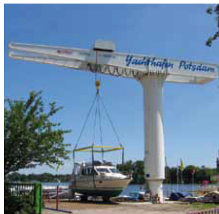
Typ: BOSS / ZW Udźwig: 25.000 / 6.300 kg Dł.ramienia: 6.500 / 12.500 mm Lokalizacja: D-Potsdam / Havel
